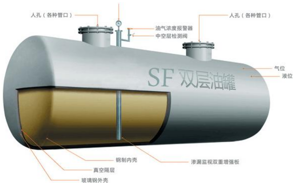
图 2-1 双层油罐剖面图
