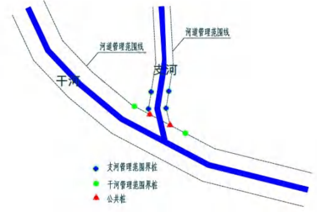
图 4.3-1 干支流交汇有控制性建筑物
