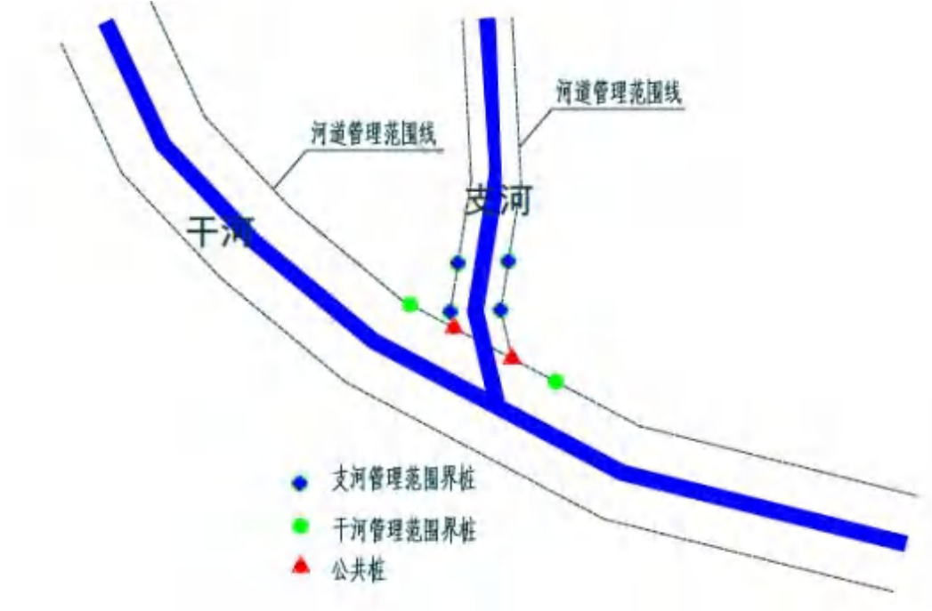
图 4.3-1 干支流交汇有控制性建筑物
