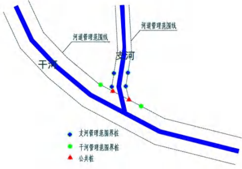
图 4.3-1 干支流交汇有控制性建筑物
