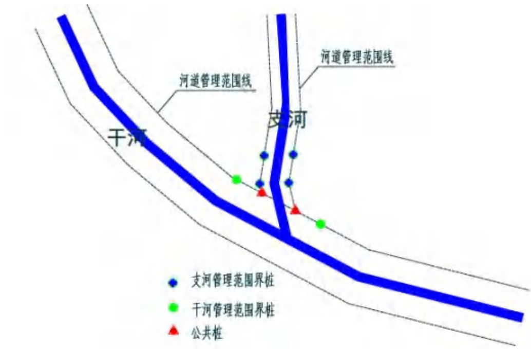
图 4.3-1干支流交汇有控制性建筑物
