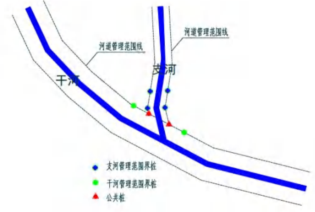
图 4.3-1 干支流交汇有控制性建筑物
