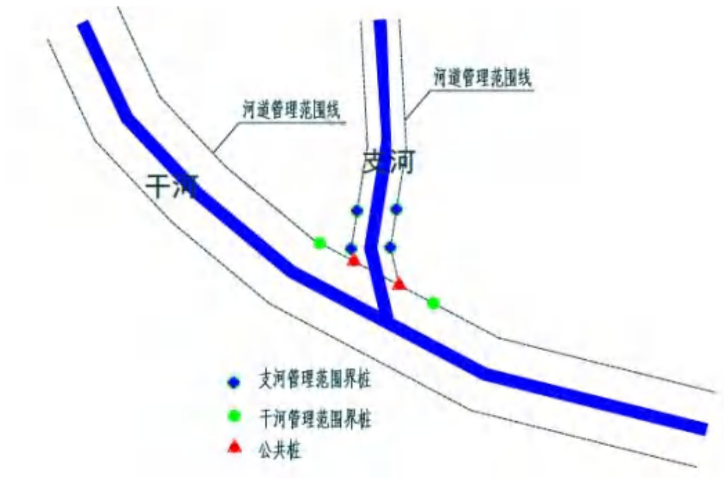
图 4.3-1 干支流交汇有控制性建筑物
