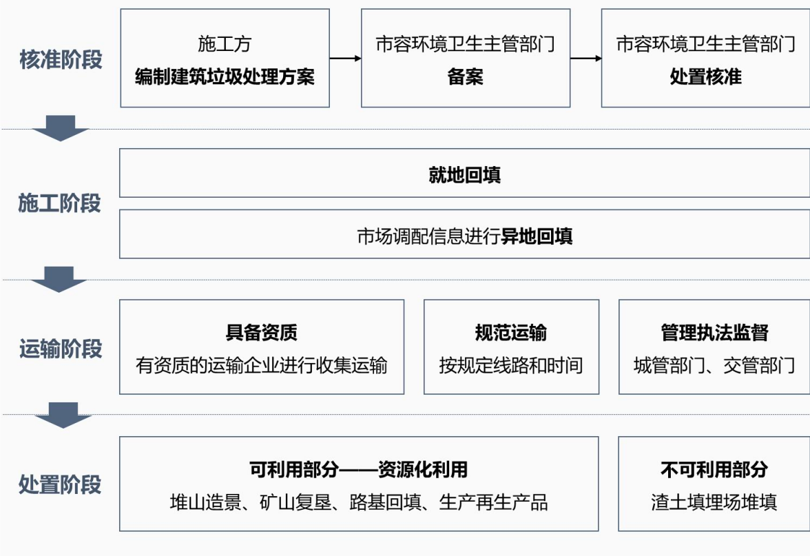
图 7-1：工程渣土收运流程图
