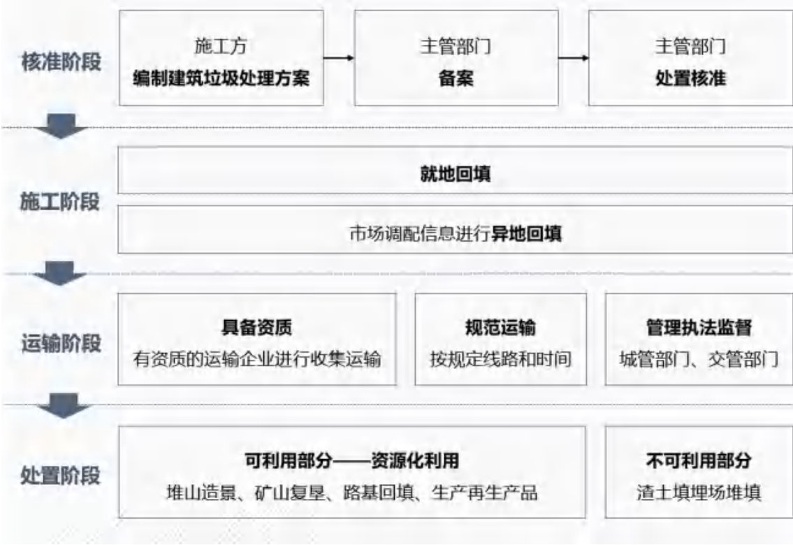
图 7-1：工程渣土收运流程图
